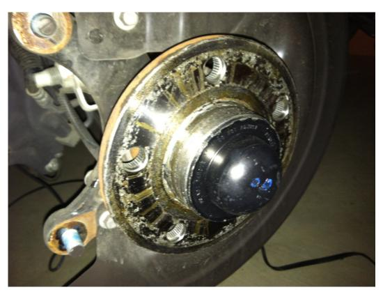
**Step 6: Installing ARP Studs**
